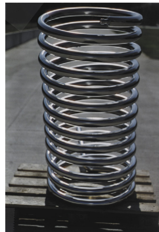
Warmtewisselaar behandeld voor weerstand tegen aankleven en hoge reinigbaarheid.
